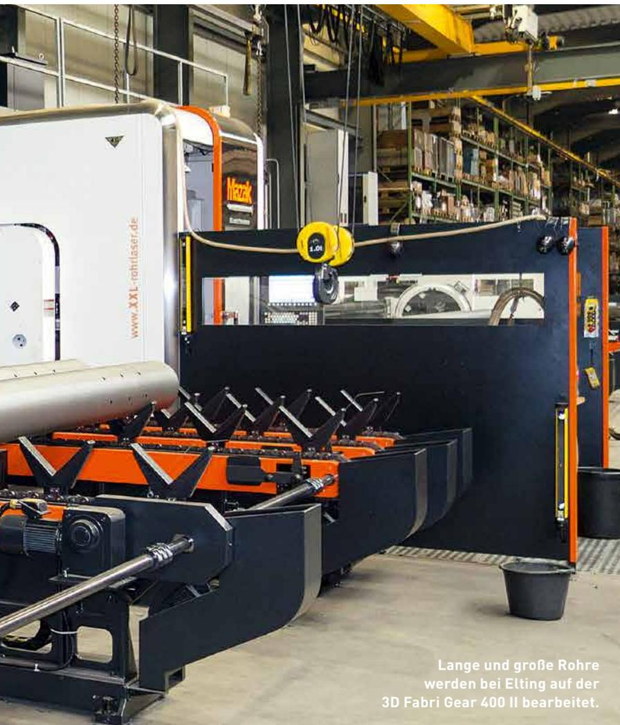
Lange und große Rohre werden bei Elting auf der 3D Fabri Gear 400 II bearbeitet.
