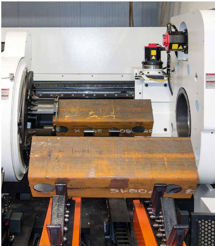
der Anlage genügend Platz für ein Jochlager; die Rohre liegen nach der Anlieferung parallel zur Anlage und können mit Kranen einfach bereitgestellt werden. Über die Fördereinheit, die fünf Rohre vorhalten kann, werden die Rohre automatisch eingezogen.
