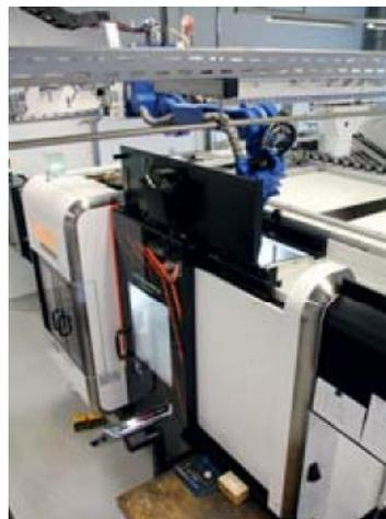
Die Multi-Funktions-Maschine Integrex i-100S von Mazak ist kompakt und ergonomisch gebaut und lässt sich von oben rüsten. Sie bleibt damit für Ma- schinenbediener optimal zugänglich.
