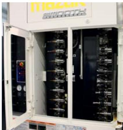
Die Werkzeugbauer erreichen mit der Mazak Integrex i-100S Oberflächengüten von  $R_z = 1 \mu\text{m}$ . Das Werkzeugmagazin stellt Platz für 72 Fräswerkzeuge bereit.
