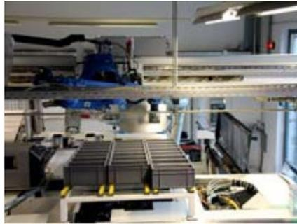
Wefa Singen arbeitet mit Plastikkisten, die auf dem Dach der BAZ gelagert und automatisch per Barcode-Label-Drucker etikettiert werden.
