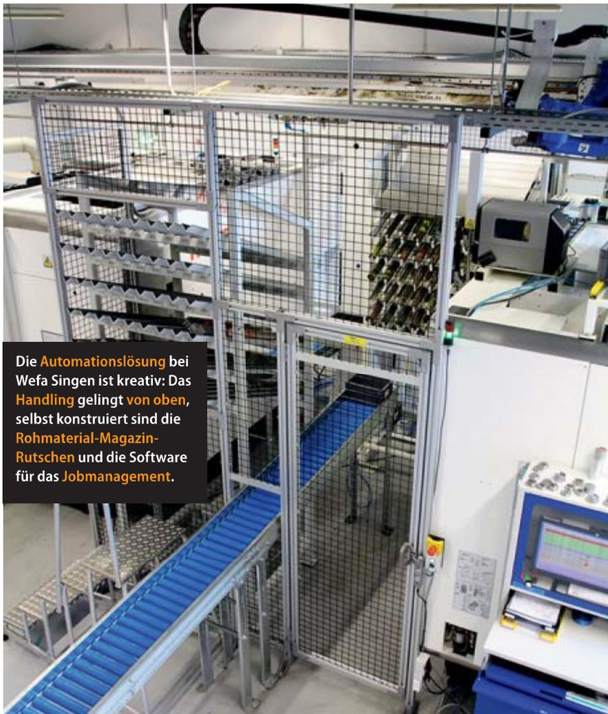
Die Automationslösung bei Wefa Singen ist kreativ: Das Handling gelingt von oben, selbst konstruiert sind die Rohmaterial-Magazin-Rutschen und die Software für das Jobmanagement.
