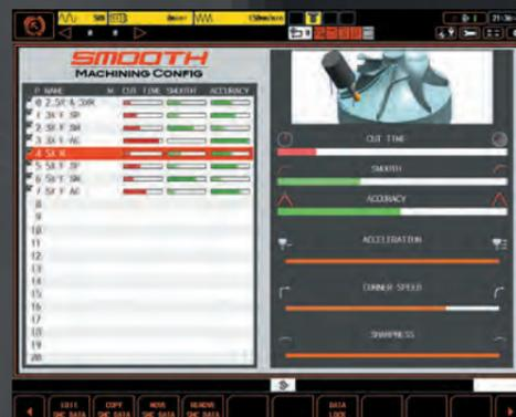
Bearbeitungsmerkmale wie Zykluszeit, Oberflächengüte der bearbeiteten Fläche und Bearbeitungskontur können mithilfe von Schieberegler am Bildschirm in Abhängigkeit von den Materialanforderungen und Bearbeitungsverfahren eingestellt werden.
