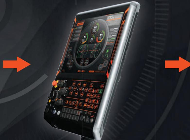
Bestimmung des Material und Vorschlag für die Werkzeugauswahl und Vorschubswerte durch die Steuerung mit grafischer Ablaufkontrolle des Bearbeitungsweges.
