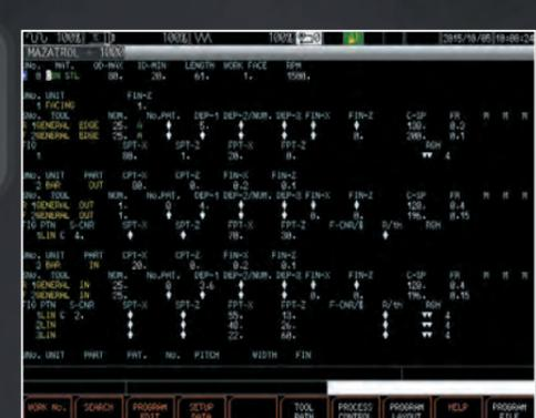
Die MAZATROL-Dialogprogrammierung arbeitet mit Dialogsprache und bestimmt automatisch Schnittbedingungen, M-Codes und G-Codes. Selbst Anfänger können somit ganz schnell Programme erstellen.
