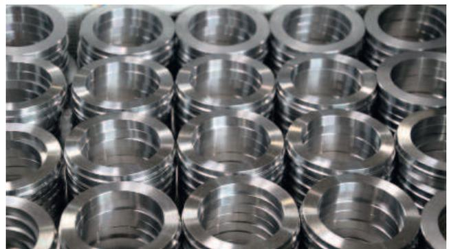
Werkstücke im Bereich zwischen 5 und 250 mm sind die Domäne bei Schäffer. Dabei wird bis Durchmesser 80 von der Stange gefertigt, darüber als Futterteil.
