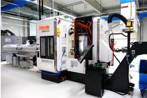
*Die beiden INTEGREX-i 150-Maschinen sind mit einem 3-m-Stangenlader für Durchmesser 25 bis 65 mm automatisiert*
