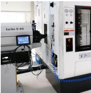
*Die Anbindung des Stangenladers und die Beladetür des Werkzeugwechslers sind an der linken Maschinenseite gut zugänglich*
