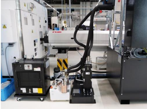
*Die neue INTEGREX-i 150 wird durch den Anschluss an die Ringwasserleitung temperaturstabil gehalten*
