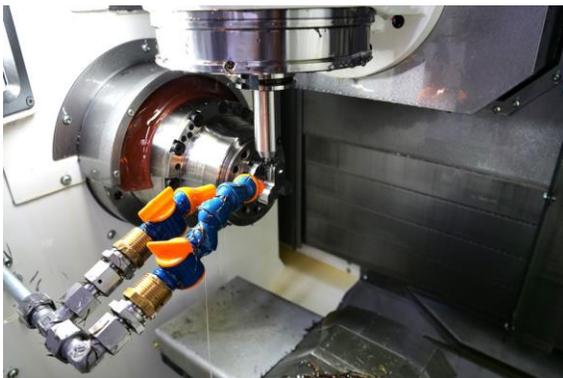
*Die Hauptspindel hat einen integrierten Spindelmotor mit Drehzahl 5.000 U/min*
