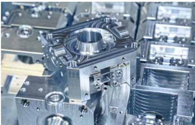
Typisches Bauteil, wie es mit dem Pallettech-System gefertigt wird. Zu bearbeitende Materialien sind Aluminium, Kunststoffe oder Edelmetalle.
