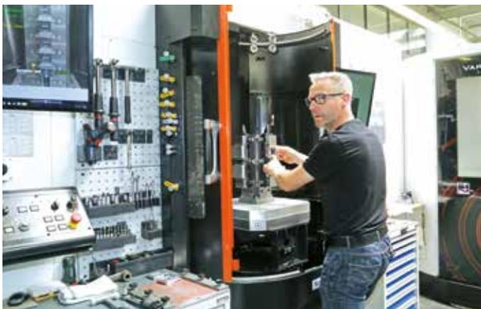
Noch Handarbeit: Die Bestückung des Pallettech-Systems erfolgt manuell, während in den Maschinen andere Aufträge abgearbeitet werden.
