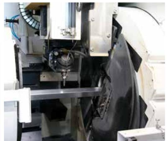
**Der 3D-Schneidkopf mit Schwenkfunktion** arbeitet überaus präzise, auch bei Schweißfasen oder Senkungen.
