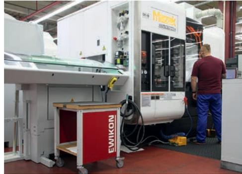
Aktuelle Generation: Die Integrex I-100S mit Mazatrol Smooth-X-Steuerung ist eine der zentralen Maschinen der Druckrohrfertigung.
