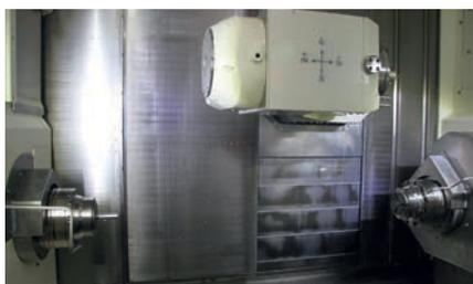
Zwei Spindeln: Auf den Mazak-Dreh-Fräszentren werden die einzelnen Bearbeitungen der Druckrohre auf einer Maschine zusammengefasst.
