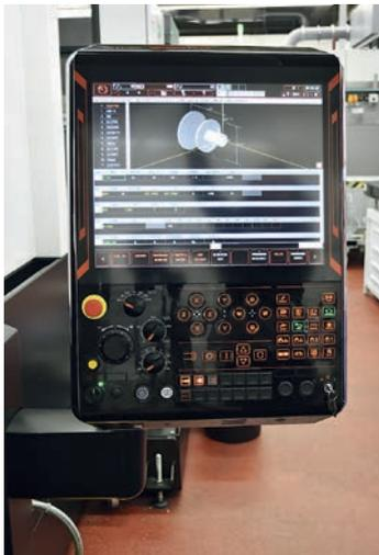
Die Mazatrol-Smooth-X-Steuerung der Integrex-Maschinen sorgt für eine einfache Bedienbarkeit auch bei komplexen Bearbeitungen.
