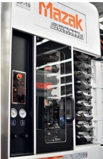
Genügend Werkzeuge: Für die Bearbeitung der komplexen Druckrohre ist das große Werkzeugmagazin mit 110 Plätzen von Vorteil.
