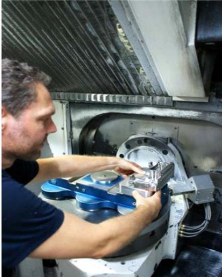
*Die 5-Achsbearbeitungszentren Variaxis können bei Bedarf dank Nullpunktspannsystem auch manuell gerüstet werden.*
