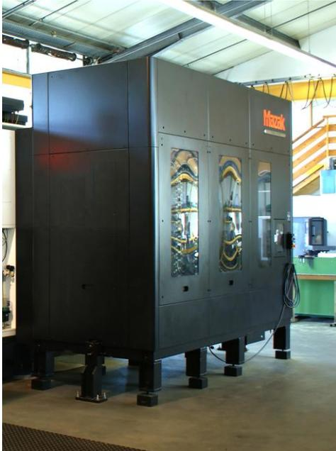
*Das Mazak Tool Hive Werkzeugmagazin fasst bis zu 500 Werkzeuge für die unterschiedlichsten Bearbeitungen*
